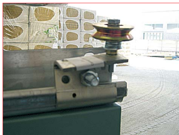
STAFFA CONTRAPPESO IN CODA CON RUOTA
