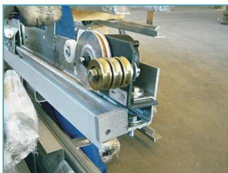
REGOLATORE CONTINUO DI CHIUSURA A 3 RUOTE (A TRE RINVII)
